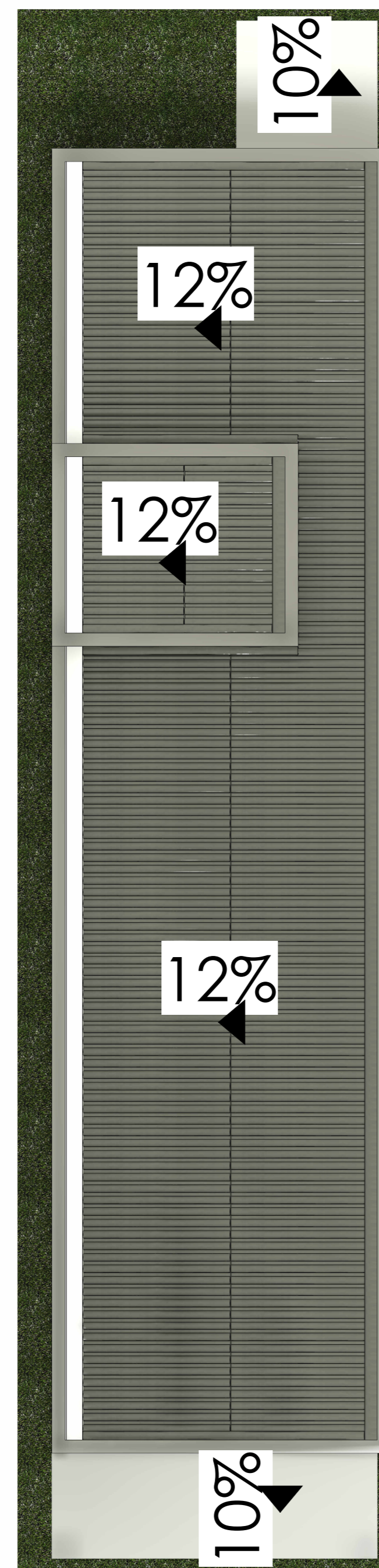
DETALHE COBERTURA ESC: 1 : 50
